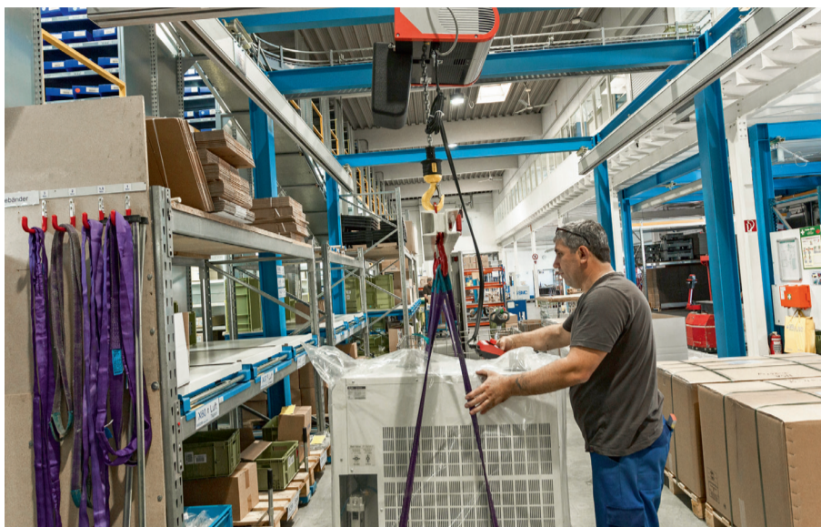
SCM Pneumatik 公司出口部和国内包装部正在使用两台 Konecranes 的单梁轻型起重机
