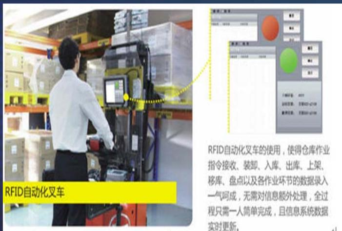
对于无人仓库，系统直接调度/自动引导执行设备的进行基于位置数据和RFID识别的入库、堆货、上架、下架、出库作业，数据自动同步到库管系统和ERP。
