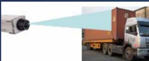
**视频识别**：采用图像提取、动态模糊消除、图像模板匹配等技术识别物体，如车牌视频识别系统
