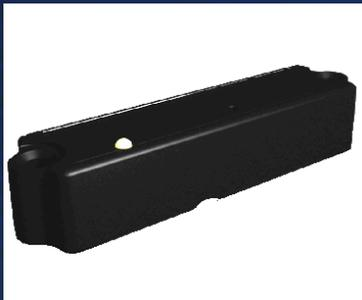
温湿度监控型：有源主动式RFID标签，集成温湿度传感，130\*35\*25 mm，用户数据区8k，433~445MHz，多标签同时识读200个，测试精度0.1，识别距离150米
