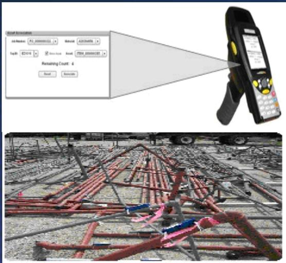
**位置管理**：当设备到达卸货场时，入场盘点阶段，在材料和设备上贴上RFID标签，该物品就有一个识别代码输入管理系统，堆场和仓库读卡器即实施材料和设备的自动库管和防盗告警功能。
